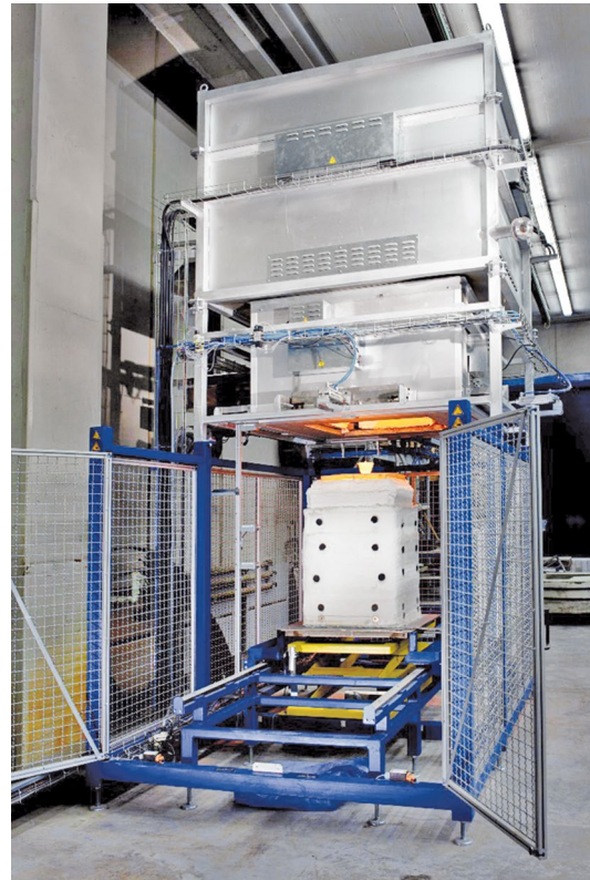
Bild 6 Hochtemperaturprüfeinrichtung der MPA Karlsruhe mit Abkühllofen (hier beim Ausfahren eines Tiegels bei der Herstellung eines Spezialzements) High temperature testing equipment of the MPA Karlsruhe with separate oven for the cooling process (photo taken during the outlet process of a crucible for the production of a special cement)
