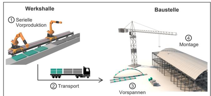
Abbildung 2: Konzept zur effizienten Herstellung und Errichtung von einfach gekrümmten Schalenträgerwerken
