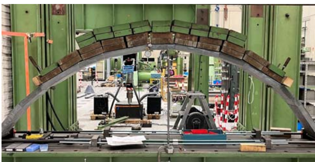
Abbildung 3: Erforschung des Tragverhaltens vorgespannter, modularer Schalenkonstruktionen durch experimentelle Untersuchungen sowie numerische Simulationen (Parameterstudien)
